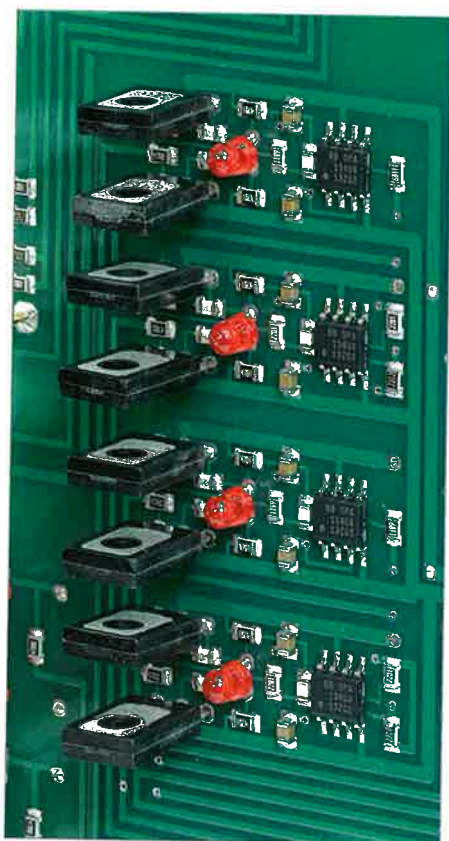
Diskret aufgebaute Ausgangsstufen des Vorverstärkers
