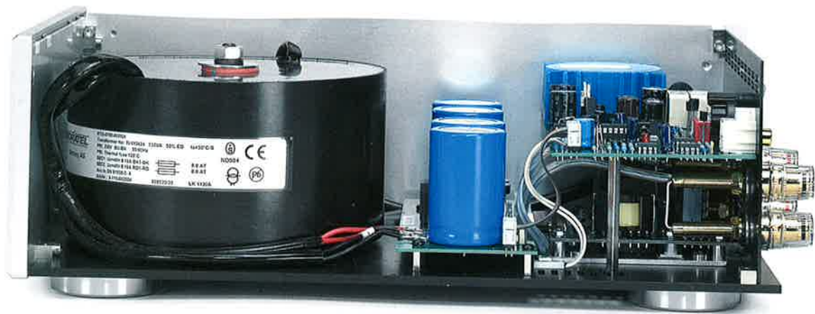
Die obere Platine rechts enthält den Steuerprozessor und die Eingangsschaltung. Das NF-Signal wird von hier symmetrisch nach unten zur Endstufe weitergereicht. Endstufe und Eingangsplatine besitzen jeweils eine separate Versorgung. Unter der Eingangsplatine (rechts oben) gibt das Class-D-Modul seine 420 Watt an bewährte Lautsprecherklemmen ab
